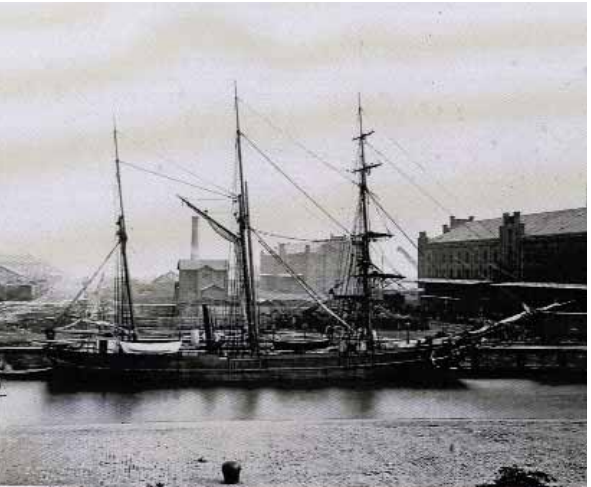
Brod „Admiral Tegetthoff“ – trojarbolni jedrenjak opremljen i pomoćnim parnim strojem snage 70 HP. Brod je nosio zalihe hrane i goriva za posadu od 23 člana za vrijeme od tri godine
